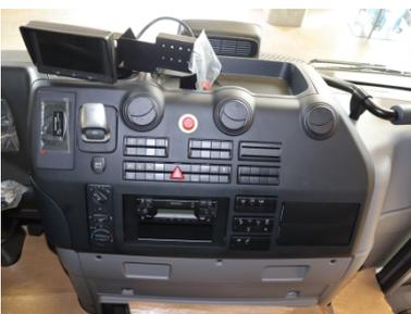
Die elektrische Schnittstelle steht für BluePower®-Fahrzeuge mit Code S4A zur Verfügung und befindet sich hinter dem mittleren Armaturenbrett. Um an die 6-polige Schnittstelle zu gelangen, muss das Mittelteil des Armaturenbrettes fachgerecht demontiert werden. Bei der Installation eines Atemalkoholtestgerätes muss die elektrische Leitung durch den Aufbauhersteller von der Schnittstelle X1.A169 im Armaturenbrett zum gewünschten Einbaort des externen Steuergerätes verlegt werden.
